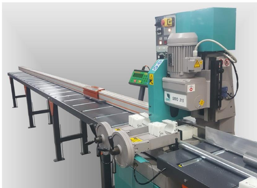
**Tables à rouleaux ou lisses avec butée manuelle ou positionneur programmable Tigerstop (en option)**
